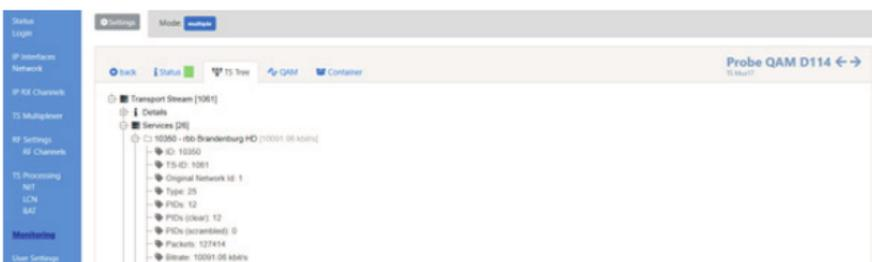
Die Komponenten eines Transportstroms werden in einer Baumstruktur inklusive der ermittelten Datenraten und PIDs übersichtlich dargestellt.
